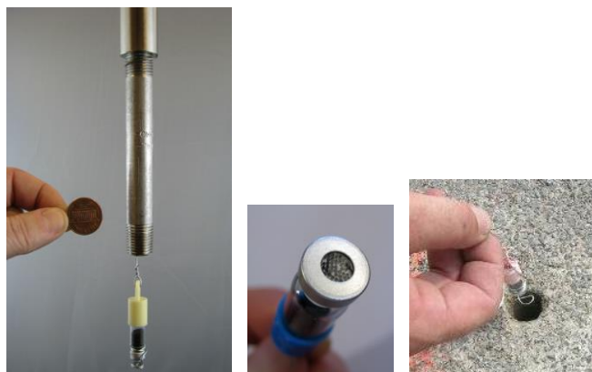
FIGURE - ILLUSTRATION DE L'ÉCHANTILLONNEUR PASSIF WMS™
