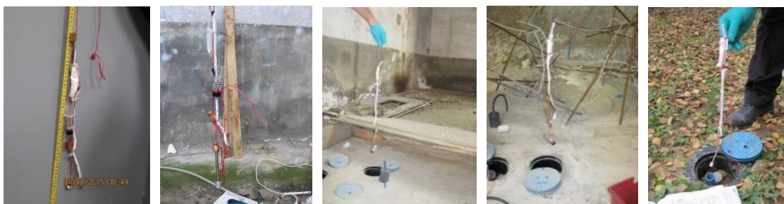
FIGURE 12 - ILLUSTRATION DE LA MISE EN ŒUVRE DES ECHANTILLONNEURS PASSIFS DANS DES PIEZAIERS
