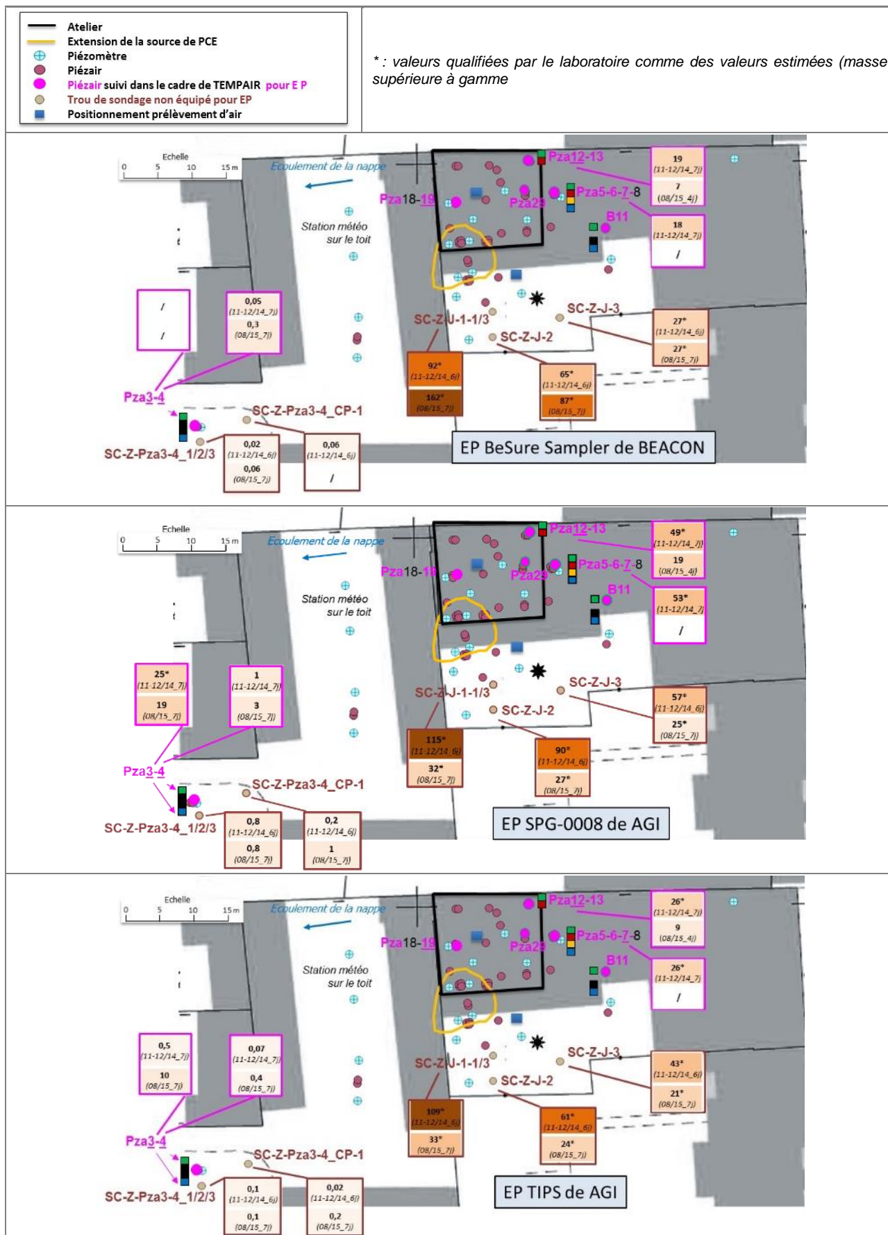
FIGURE 1 - CARTOGRAPHIE EN MASSE ( \mu\text{g} ) DU PCE DANS LES GAZ DU SOL DES TROUS DE SONDAGE DE SUB-SURFACE NON EQUIPES ET OBTURES PAR UN BOUCHON ETANCHE ET DES PIEZAIRS POUR LES « EP BESURE SAMPLER - BEACON », « EP SPG-0008 - AGI » ET « EP TIPS - AGI » POUR LES CAMPAGNES DE NOV.-DEC. 2014 ET AOUT 2015
