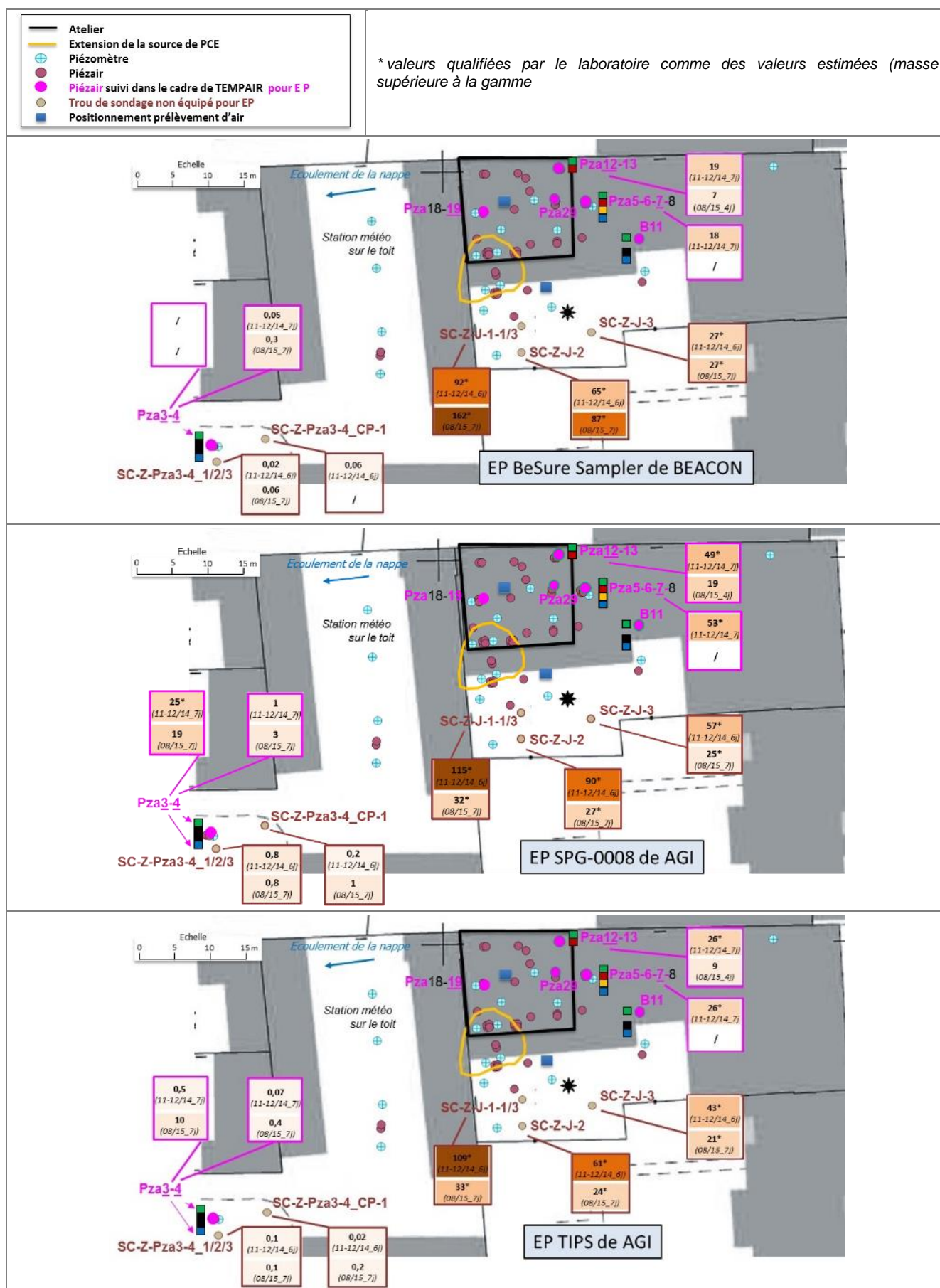
FIGURE 14 - CARTOGRAPHIE EN MASSE ( \mu\text{g} ) DU PCE DANS LES GAZ DU SOL DES TROUS DE SONDAGE DE SUB-SURFACE NON EQUIPES ET OBTURES PAR UN BOUCHON ETANCHE ET DES PIEZAIRS POUR LES « EP BeSURE SAMPLER - BEACON », « EP SPG-0008 – AGI » ET « EP TIPS - AGI » POUR LES CAMPAGNES DE NOV.-DEC. 2014 ET AOUT 2015
