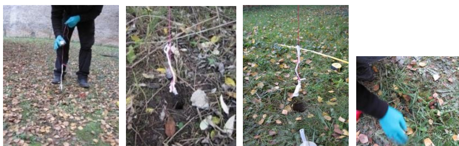
FIGURE 13 - ILLUSTRATION DE LA MISE EN ŒUVRE DES ECHANTILLONNEURS PASSIFS DANS LES TROUS DE SONDRAGE NON EQUIPES
